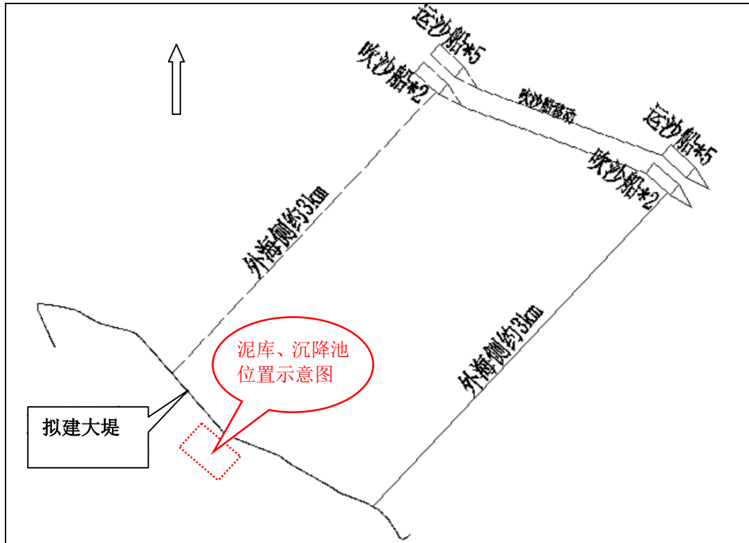
图 2.5-3 海堤加固吹运沙船布置情况
